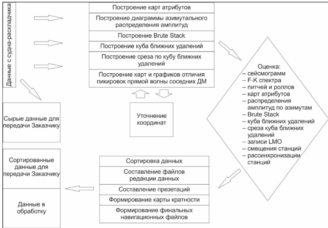
Рисунок 20. Принципиальная схема offline контроля качества на борту для данных МОГТ 3D, полученных с донных регистраторов
