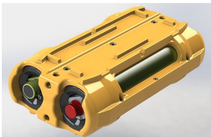
Рисунок 25. Автономный донный регистратор FLOUNDER
