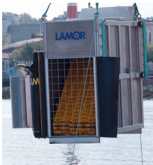
Установка нефтесборной системы
