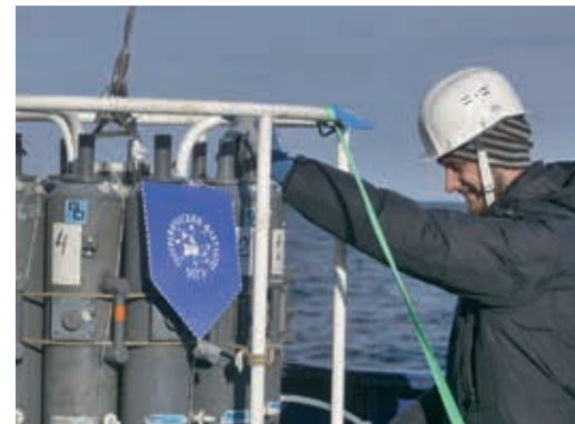
Подготовка розетты с батометрами для гидрометеорологических исследований в Охотском море
