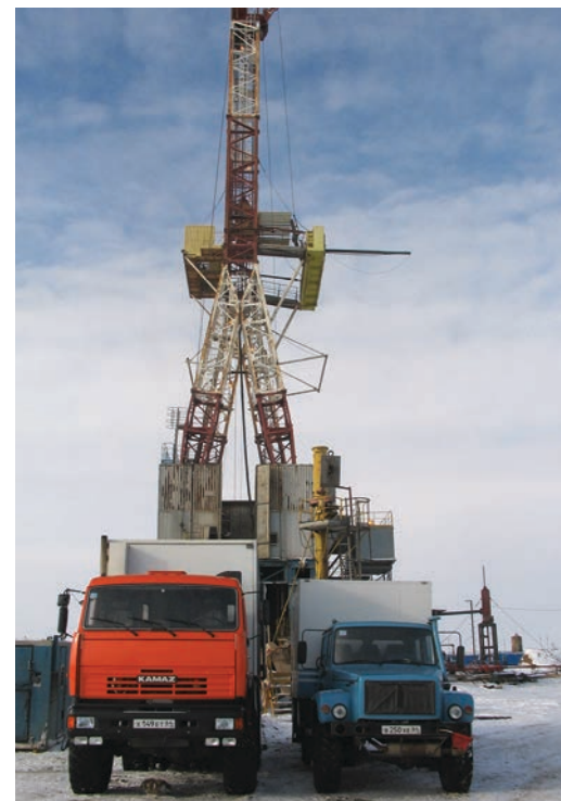
Перфорация на глубине свыше 5 км на скважине №1 Непряхинского месторождения
