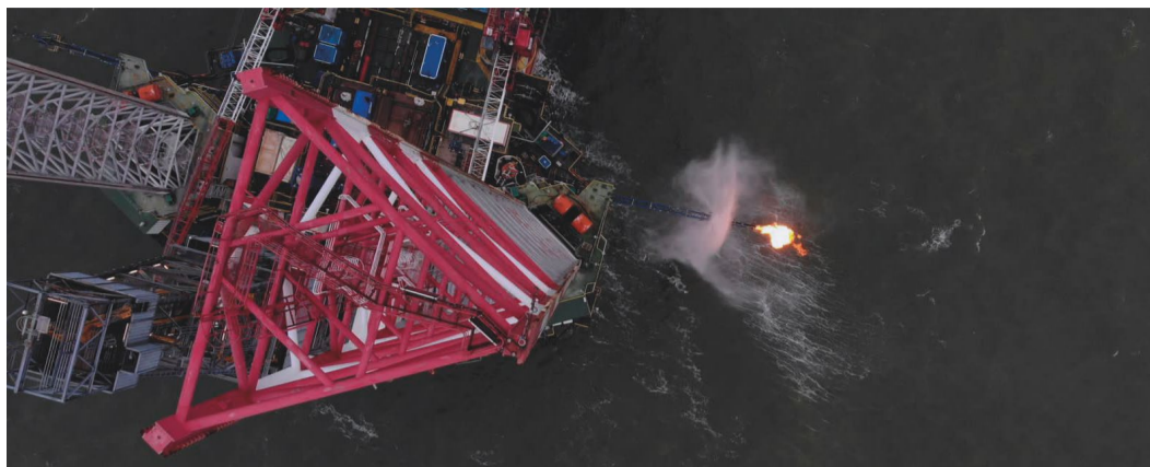
Испытания поисково-оценочной скважины на СПБУ «Арктическая»
