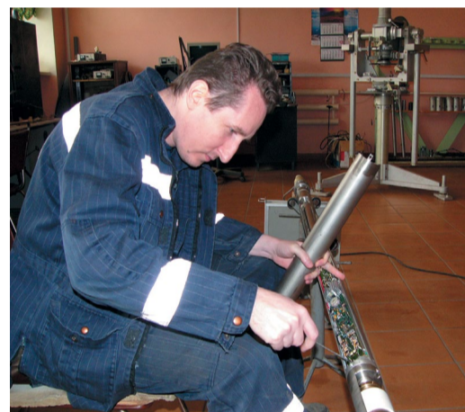
Ремонт скважинной аппаратуры
