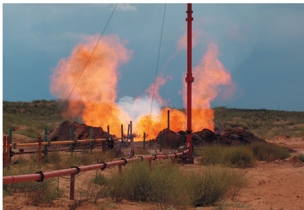
Отдувка скважины после капитального ремонта
