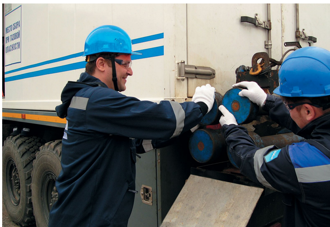
Подготовка лубрикаторных секций к сборке противовыбросового оборудования
