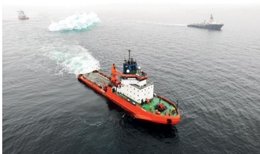
Суда буксируют айсберг одним курсом параллельно друг другу на безопасном расстоянии
