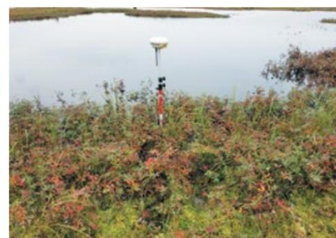
Съемка контуров местности на незастроенной территории методом GPS-наблюдений в режиме real-time kinematic
