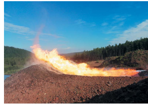
В ходе испытаний в конце августа получен промышленный приток газа
