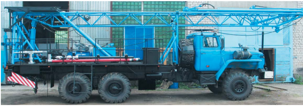
Геофизическая вышка и скважинный лубрикатор в транспортном положении
