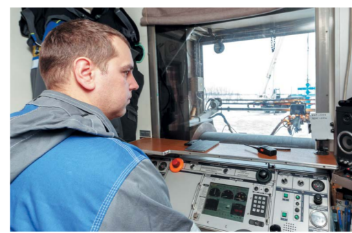
Машинист подъемника каротажной станции выполняет спускоподъемные операции при регистрации параметров скважины
