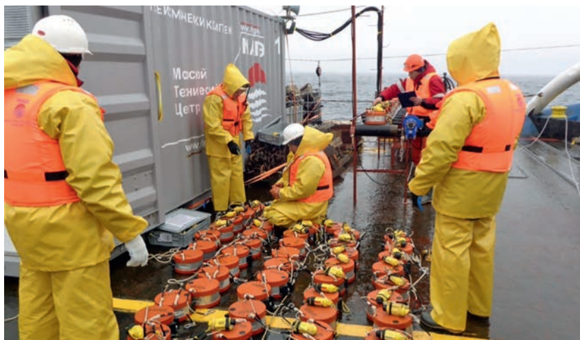
Рис. 11. Донные станции с установленными гидроакустическими маяками перед их раскладкой. Источник: АО «МАГЭ»
