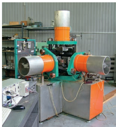
Рис. 1. Испытательная система трехосного независимого нагружения Fig. 1. Triaxial independent loading test bench
