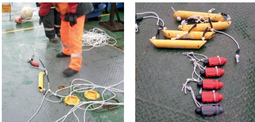
Рис. 4. Постановка маяков «Пикет» и Sonardyne. Источник: АО «АКИН»
